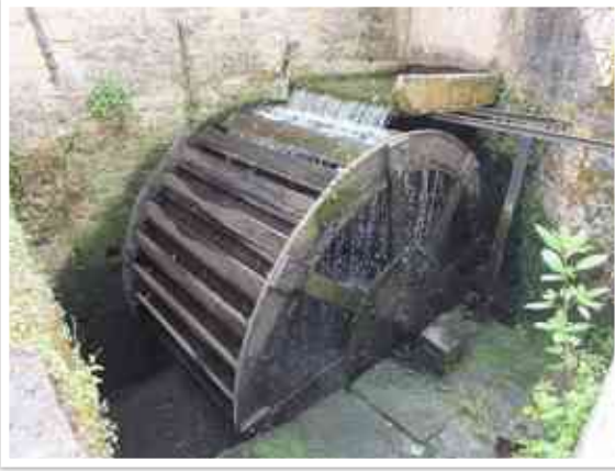
تحريك عجل بواسطة استخدام طاقة الماء
