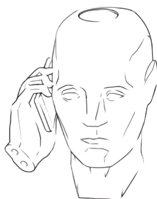
תמונה 9.4: מדידת קצב הבליעה הסגולית של הקרינה האלקטרומגנטית הנפלטת ממכשיר טלפון נייד (מקור: ראו נספח ג')
