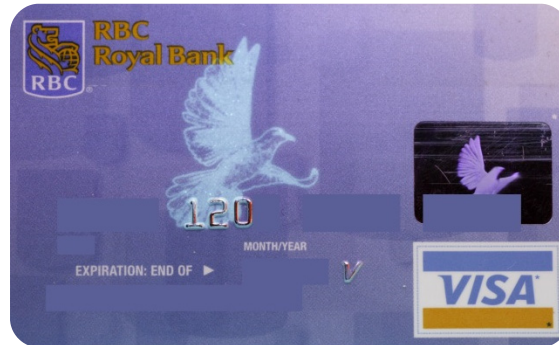
صورة 6.7 عند إضاءة بطاقة الفيزا القديمة باستعمال ضوء تروّده أعلى بقليل من تروّده الضوء المرئي، ستظهر لك صورة طائر "مختفية" لمنع التزيف. عند إضاءة بطاقات ائتمان الشركات المختلفة بالأشعة فوق البنفسجية ستظهر لك أحرف أو رموز مختلفة (المصدر: أنظر ملحق جـ)
