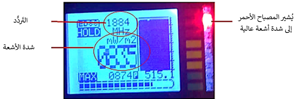
صورة 5.9 نتائج قياس الأشعة المنبعثة من مُقعد هاتف لاسلكي بيئي.
