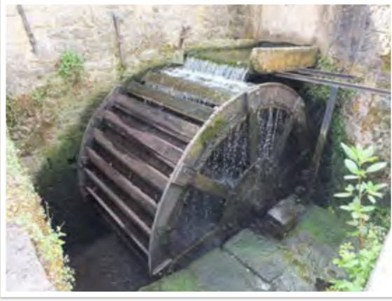
تحريك عجل بواسطة استخدام طاقة الماء
